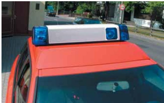
Sicherlich alltäglich, eine Hella RTK 6-Anlage, beim KDOW jedoch mit zusätzlichem Blinklicht nach vorne
